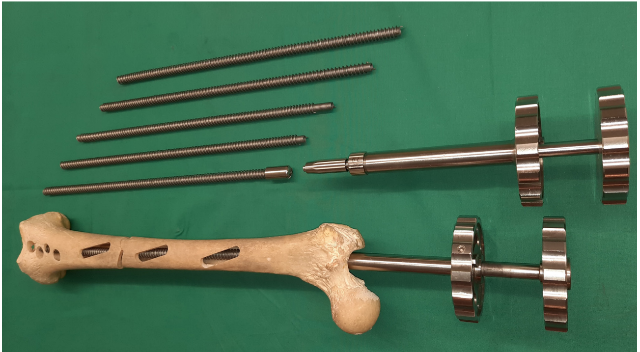
Federdraht als Doppelhelix zur Frakturfixierung
